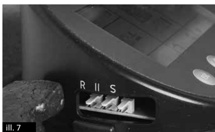
collegamenti sul lato sinistro del display: Linea di segnale (R), sensore di conducibilità (II), linea di impulso (S)
