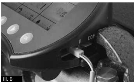
collegamenti a destra: sensore di conducibilità (II) Preparazione della comunicazione bidirezionale (COM)
