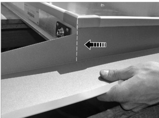
Fig. 65: spinta della lamiera superiore laterale verso l'alto contro la battuta
