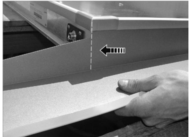
Fig. 57: spinta della lamiera superiore laterale verso l'alto contro la battuta
