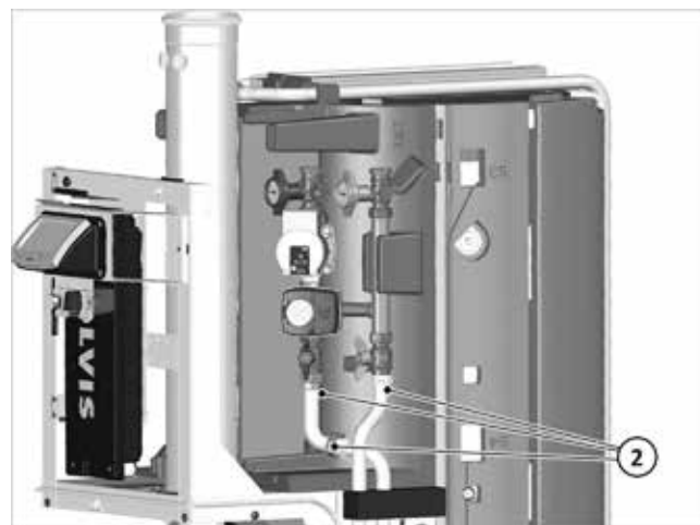
Fig. 9: Rimuovere i pezzi di tubo (2)
