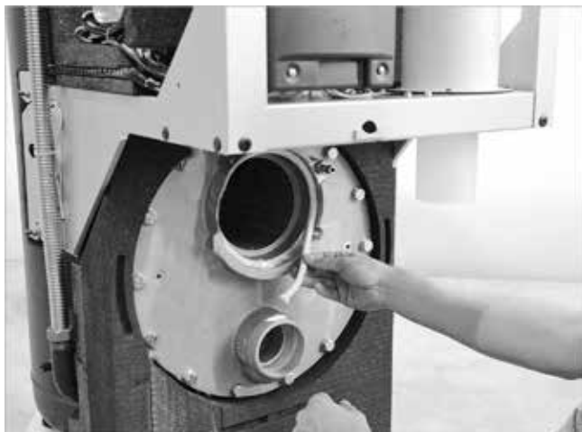
Fig. 64: Inserire il cordoncino di tenuta del bruciatore
