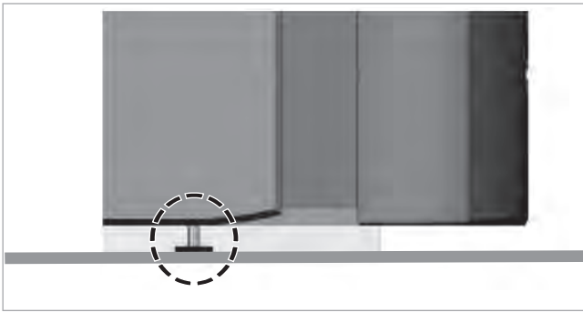
Fig. 129: Estrazione dei piedi d'appoggio delle parti laterali.
