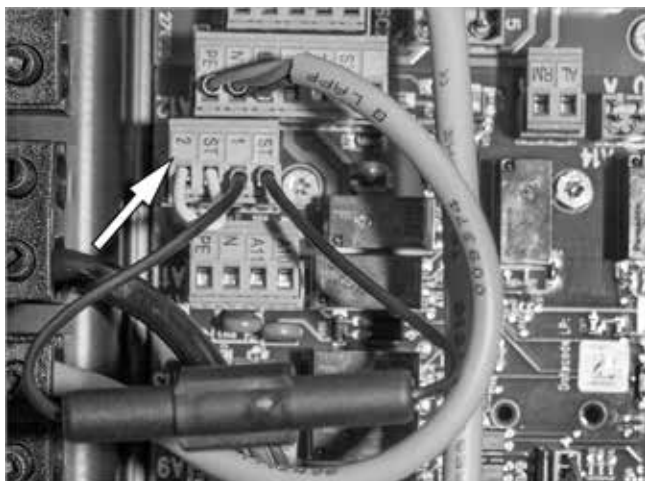
Fig. 57: Inserire la presa di collegamento
