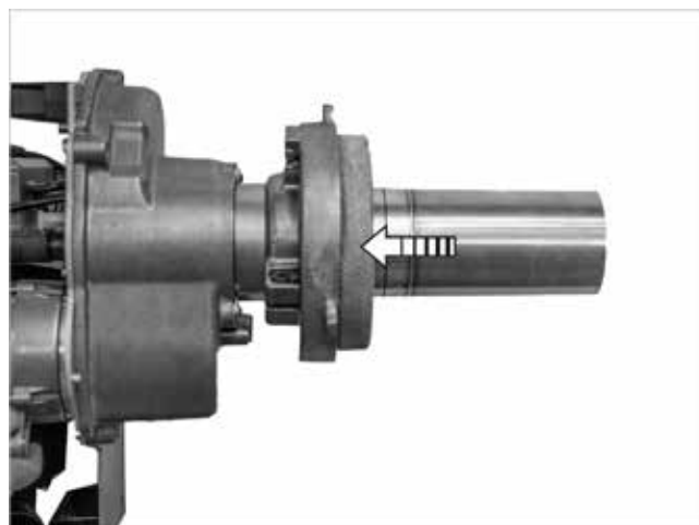
Fig. 67: applicazione del portello caldaia con isolante refrattario
