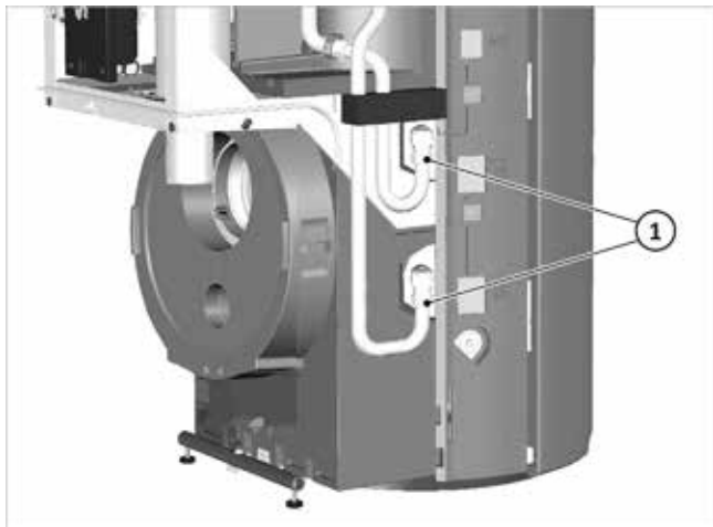
Fig. 31: Controllare/serrare gli attacchi della SCR
