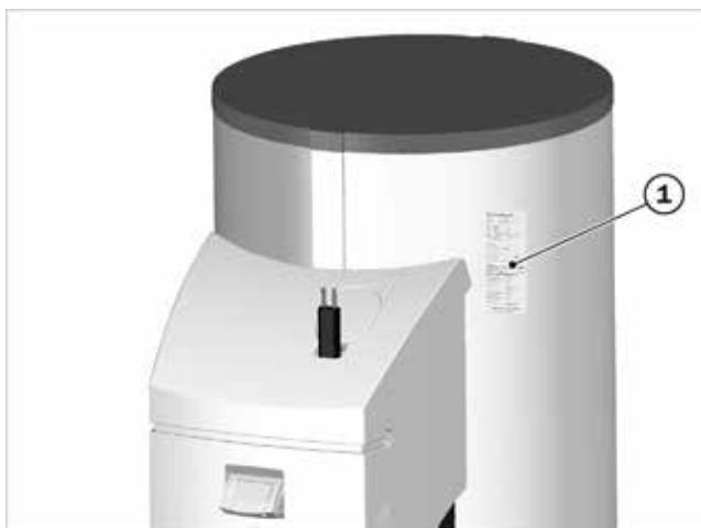
Fig.108: copia della targhetta (1) applicata sull'isolamento
