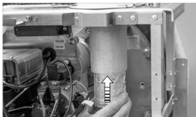
Fig. 61: Montaggio fonoassorbente per la parte interna del tubo
