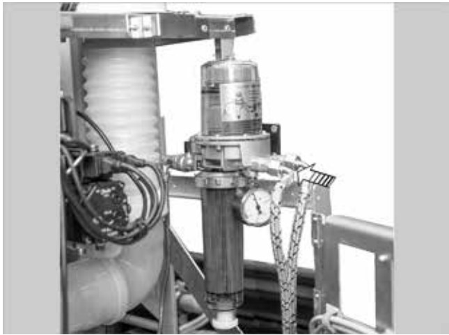
Fig. 68: allacciamento della tubazione dell'olio
