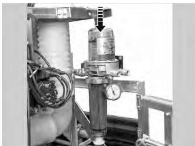
Fig. 67: inserimento del filtro dell'olio
