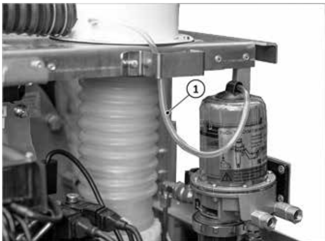
Fig. 70: tubo flessibile di sfiato montato
