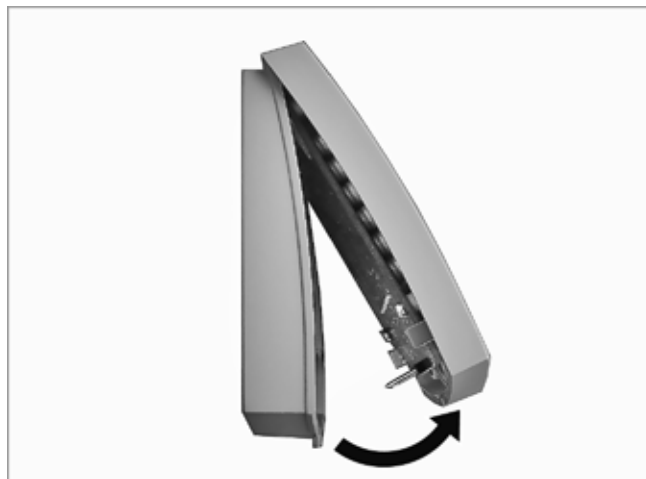
Fig. 94: apertura del contenitore
