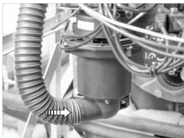
Fig. 58: Fissaggio del tubo flessibile per l'aria di alimentazione nel soffiante
