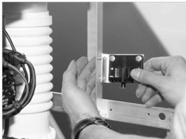
Fig. 66: Fissaggio del supporto del filtro dell'olio
