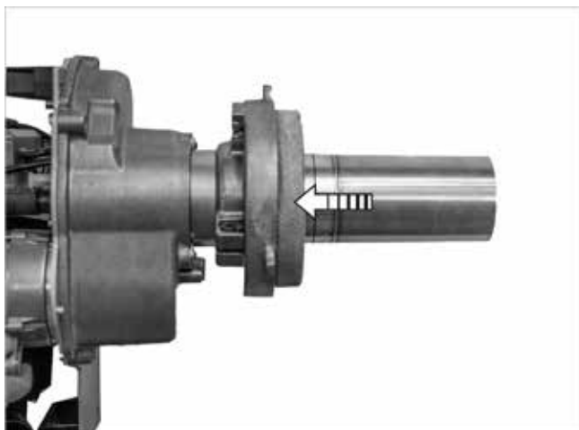
Fig. 55: applicazione del portello caldaia con isolante refrattario
