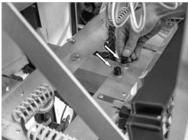
Fig. 33: Copertura delle teste delle viti
