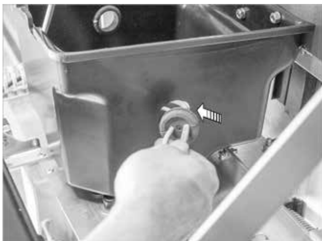
Fig. 35: Passaggio del cavo del bruciatore in modo che rimanga stagno
