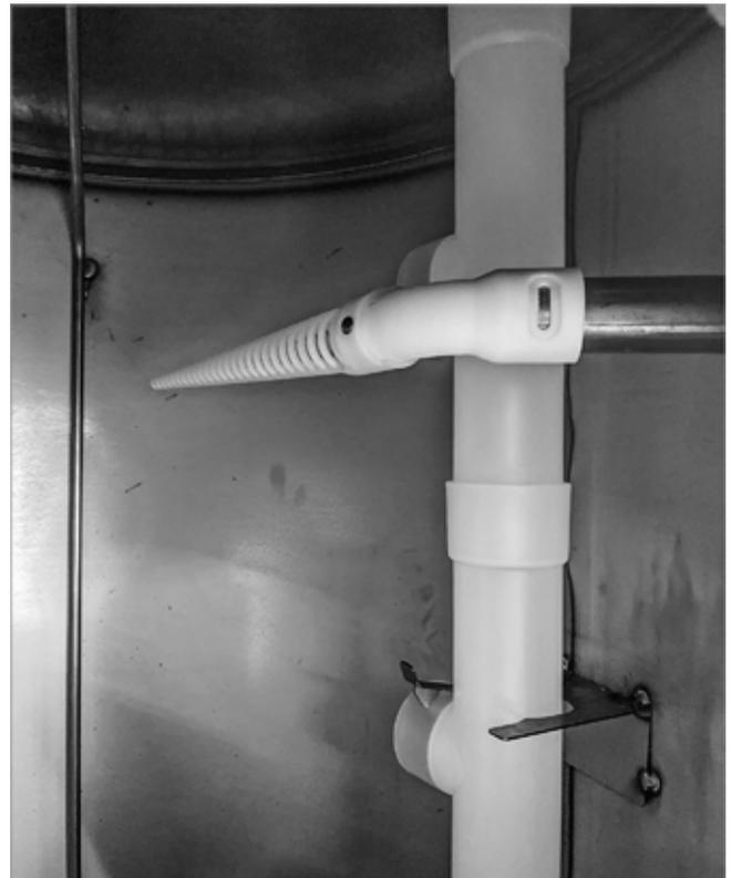
Fig.18: Lancia di carica con angolo
