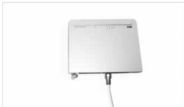
Fig. 6: Collegamento del cavo LAN al router
