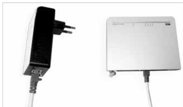
Fig. 8: Collegamento dell'adattatore PowerLine al router
