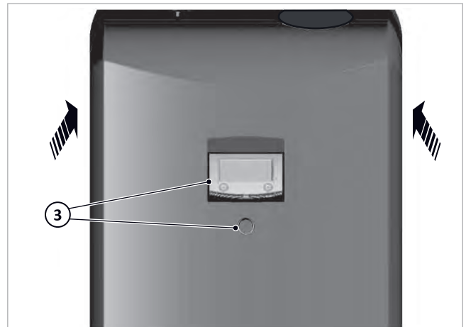
Fig. 76: Spinta della copertura anteriore
